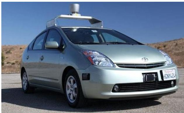
*Figura 4: Veículo autônomo sendo correntemente estudado pela Google, com LIDAR Velodyne de geração anterior ao que estamos adquirindo.*
