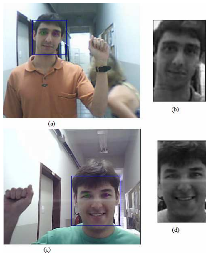
Figura 33 – (a) – Imagem captura pela webcam usada nos experimentos ; (b) - a mesma imagem após ser recortada e escalonada. (c) – Imagem captura por uma webcam com resolução de 1.2 Megapixels ; (d) - a mesma imagem após ser recortada e escalonada.
