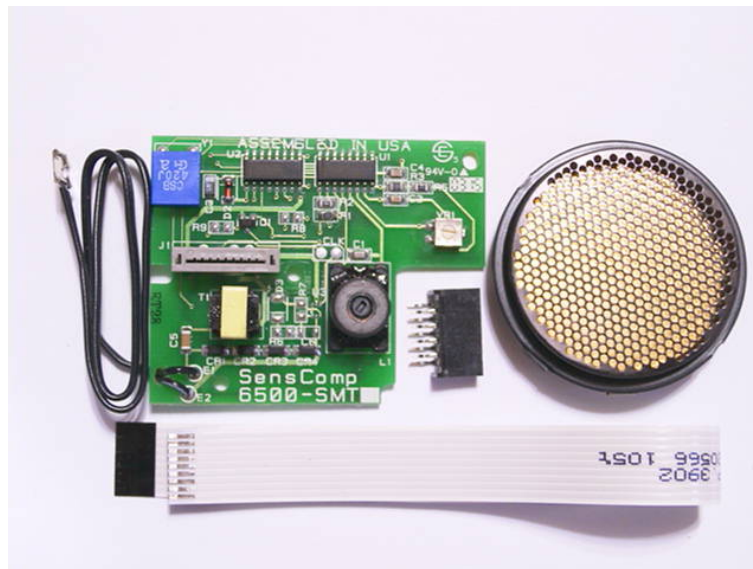
Figura 3.5: Sensor Polaroid Série 6500
