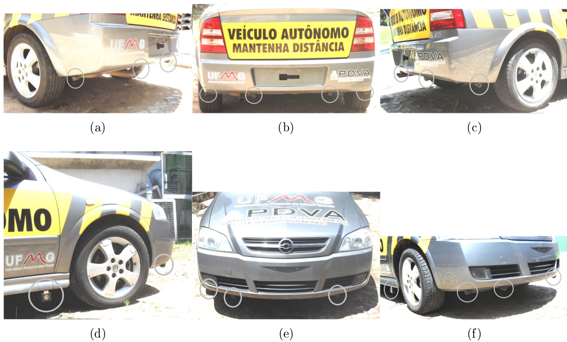
Figura 3.17: Locais de instalação dos sensores no veículo
