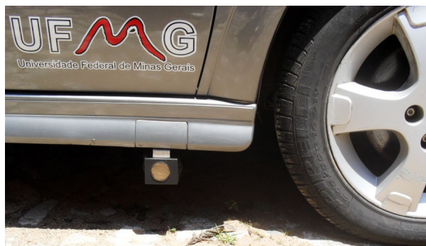
Figura 3.15: Local de instalação do sensor Polaroid 6500
